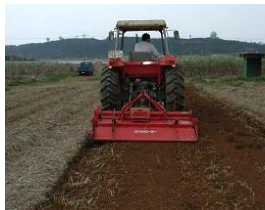
図4 ロータリーによる碎土
