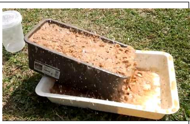
図8 裸地状態で雨に当たることで土が流れる
