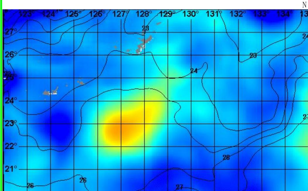
図1. 海況案内人による表面水温(等温度線)・海面高度分布(塗り分け)図(2020年12月31日)
