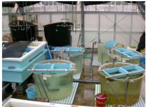
写真1 銅イオン試験のための飼育水槽の設置状況
