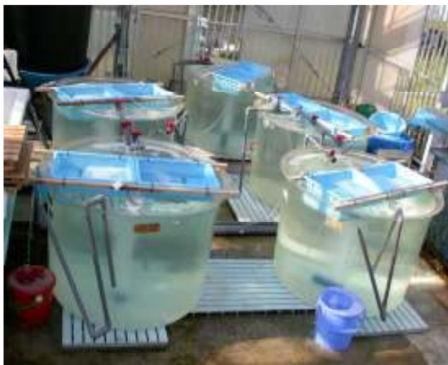
写真1 ヒレジャコの銅イオン試験状況
