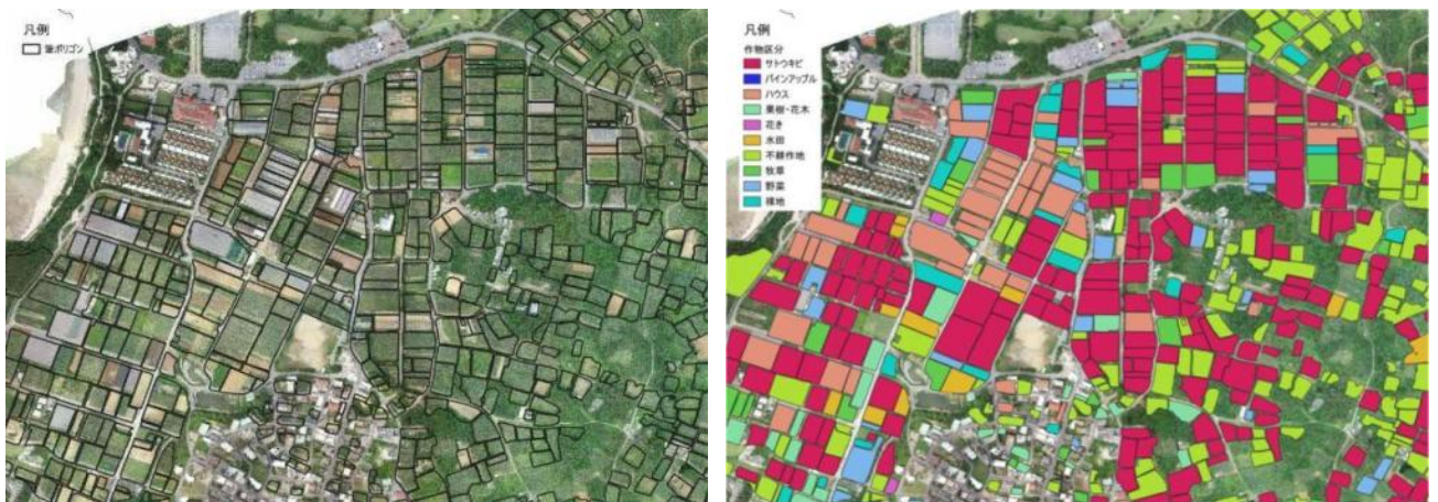
図 7.2-9 ドローン画像に筆ポリゴン配置図(左図)、AI による作物種判定結果例
