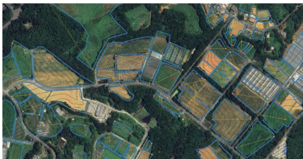
図 7.2-7 圃場整備前の地形情報(DEM)の残存範囲例 (図内等高線は、国土地理院 10mDEM による等高線(1mピッチ))
