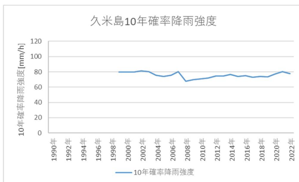
図 8.2.2-14 久米島 10 年確率降雨強度推移
