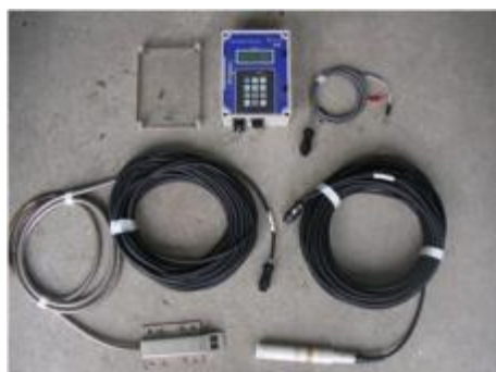
水位・流速計 (RT510-1VW・東建エンジニアリング)
