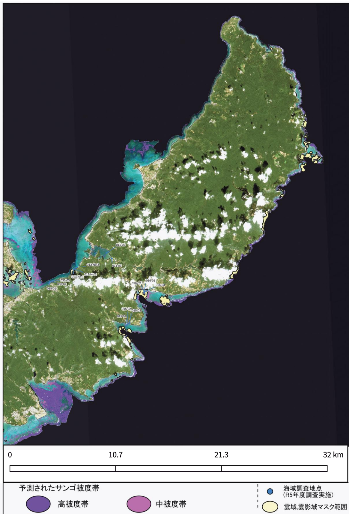
図 1-26 人工衛星画像解析による、サンゴ等生息状況解析 ランダムフォレスト法による沿岸海域分類(本島北部エリアの抜粋掲載)
