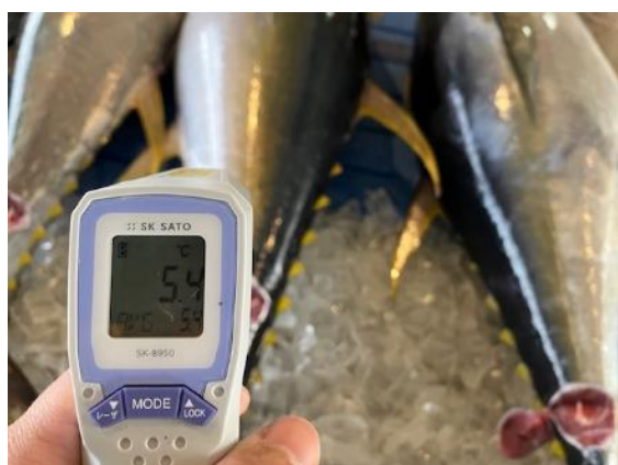
図1 非接触型の放射熱温度計を活用した名護市場上場物の表面温度測定支援(北部広域実証調査)
