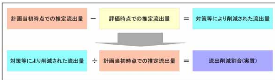
図 4-1 「計画当初時点での推定流出量」と「評価時点での推定流出量」による評価
