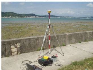
図 6-9 測量用 GPS (RTK-GPS)
