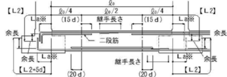
図1.5 主筋の継手、定着及び余長（その1）
