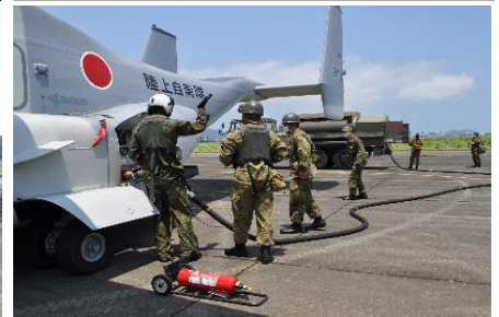
航空機への燃料補給・整備
