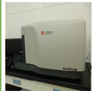
青・赤・紫の3レーザー、10カラーフィルター搭載のセルアナライザー。前方散乱光で検出する。FCM解析ソフトkaluzaも使用可能。
