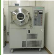
生物試料(植物組織、タンパク質等)の水分を除去する棚式の大型凍結乾燥機。トラップ冷却温度-45℃、除湿量10L/回、乾燥棚温度-10~40℃。
