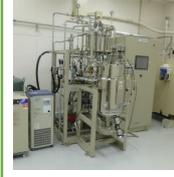
90Lの自動培養装置。藻類や微生物を自動運転で培養でき、培養タンク内のDO、CO<sub>2</sub>濃度・温度・攪拌速度を自動制御することができる。
