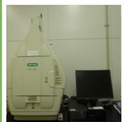
蛍光及び可視染色サンプルのゲルやプロットの撮影解析が可能。高感度の化学発光検出も出来、切り出し時にサンプル・実験者ともに保護するアクセサリも付属している。冷却CCDカメラ搭載。
