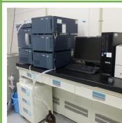
粒子径2µm以下の充填剤を用いることで溶液中の複数の化合物成分の短時間、高精度な分離操作・濃度分析が可能な超高速液体クロマトグラフィー。eλ PDA(190~800nm)、ELS(エバポレート光散乱)の2種の検出器を選択可能。
