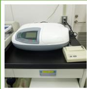
波長域は190~900nmで、キセノンランプ使用。データは感熱ロール紙に出力。
