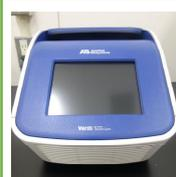
0.1°C単位の温度によるプログラム運転が可能で、異なるアニーリング温度を利用して複数の反応を最大6ラン同時に行える。0.2mlのシングル・8連チューブ、96wellマイクロプレートに対応。
