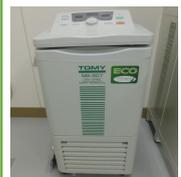
冷却機能付きの遠心機。チューブタイプは2、15、50mlで、最大2ml×72本の大量遠心が可能。96ウェルプレートにも対応している。ラック AR015-24、AR510-04、PCR96-02
