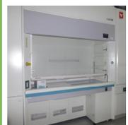
有機系物質を吸着する乾式の排気ガス処理装置を有する作業台。気流制御が可能で、定風速で動作する。
