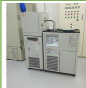
生物試料(植物組織、タンパク質など)の水分を除去する棚式の小型凍結乾燥機。トラップ冷却温度-45℃、除湿量4L/回、乾燥棚温度-40℃~30℃。
