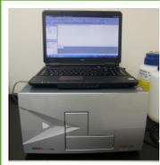
上方・下方蛍光測定、吸光測定、FRET測定など主要な測定方法に幅広く対応している。温度制御により、細胞・生化学アッセイも可能である。吸光測定波長は230~1,000nm
