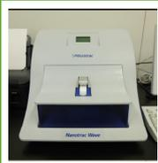
ナノ粒子の物性(粒度分布、ゼータ電位、分子量)測定を行う。ナノ粒子実用化のための分散・凝集特性評価などが可能で、ナノ粒子製剤の基礎研究や製造開発に有用。動的光散乱法(DLS)および周波数解析(FFT-ヘテロダイン法)で測定。測定範囲は0.8~6,500nm。
