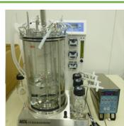
pH、DOの計測及び消泡剤注入の制御が出来るコントローラーを備え付けた10Lの卓上型の培養装置。培養槽内の温度・攪拌速度を自動制御可能。槽内温度調整:供給水温+5℃~50℃。攪拌速度調節:100~800rpm。通気流量調整:1~10SL/min。pH指示制御範囲:2.00~12.00。
