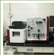
抗体などタンパク質やペプチドなどの生体分子を精製する生体分子精製用液体クロマトグラフィーシステム。イオン交換、ゲル濾過、逆相などすべての分離方法をカバーした基本プログラムが入力されている。システムポンプは流速: 0.001~25ml/min、耐圧: 20Mpaの範囲をカバー。検出: UV、電気伝導度。
