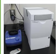
核酸・タンパク質のサイズ測定や定量をオンチップで分析。(専用の試薬キットを用いRNA、DNA、タンパク質、細胞の4つの分析が可能。)また、次世代シーケンサー用DNAサンプルのQCにも有効。
