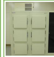
マウス・ラット用の個別型飼育装置(6室)。+5°C~45°Cの範囲で2段変温機能付き。吸気(HEPAフィルタ)・排気(脱臭フィルタ)のバランス調整が可能。各室の照明はタイマーによる昼夜の明暗切替と調光を個別制御可能。
