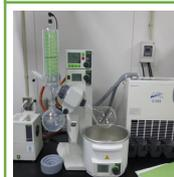
回転数は20~280rpm、恒温水槽の温度調節は室温+5℃~180℃まで可能。回転フラスコ許容量は50ml~4,000mlまで対応。
