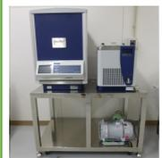
突沸防止機能、インバランス対応(85gまで)、サンプル温度制御機能付きで、最高回転数は1,800rpm、エッペンチューブ、プレート、試験管、バイアルからフラスコまで様々な容器の使用が可能。
