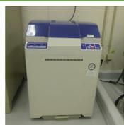
100Lの大容量サイズのオートクレーブ。液体や器具の滅菌、寒天培地の溶解に使用できる。
