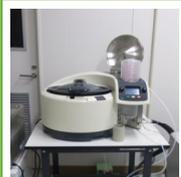
専用フラスコ450ml×6本を同時に濃縮する遠心エバポレーター。アルコール、水、酢酸エチル、TFAなどの溶液の濃縮が可能。
