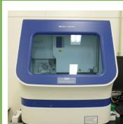
蛍光ジデオキシ法により標識された反応生成物を8本のキャピラリーで同時電気泳動・解析が可能。シーケンスのリード長は850塩基以上。
