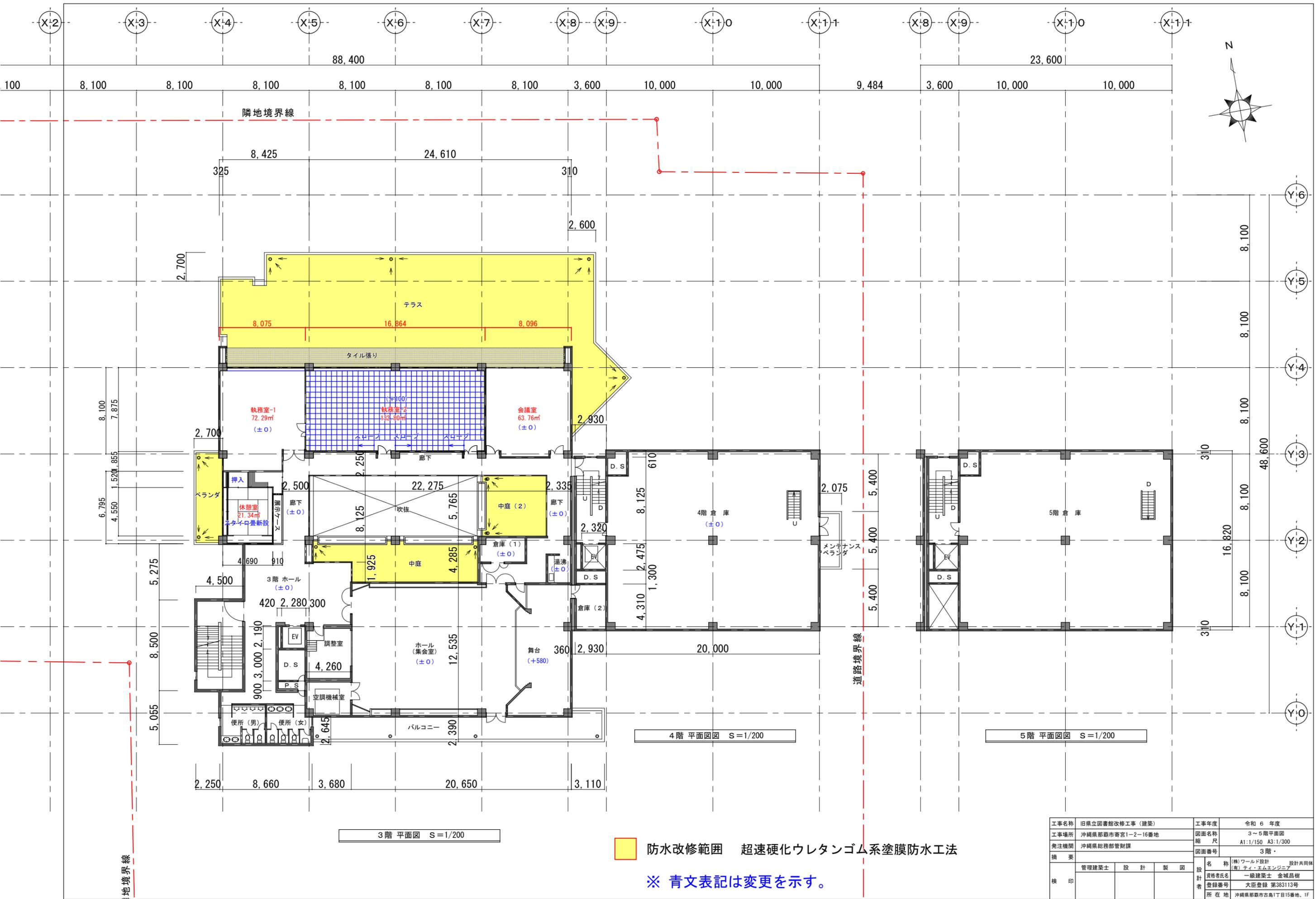
防水改修範囲 超速硬化ウレタンゴム系塗膜防水工法
