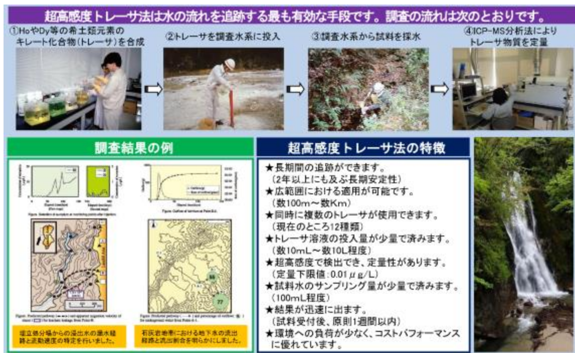
図Ⅲ-3-16 超高感度トレーサ法の概要
