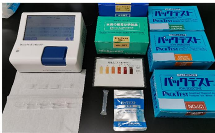
図 デジタルパケットテスト SP (左側装置)、およびパケットテスト (共立理化学研究所)
