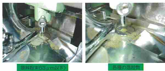
造粒技術によって流動性が改善した!! 流動性は品質(錠剤重量)に影響を及ぼす!! 図3 造粒技術による流動性の改善
