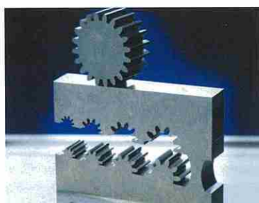
ワイヤーカット放電加工機での加工例 (株式会社ソディックのカタログより抜粋)
