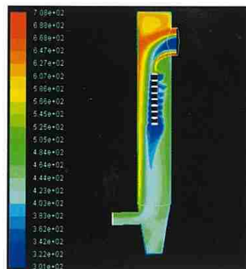
図1 冷却塔内の温度分布例
