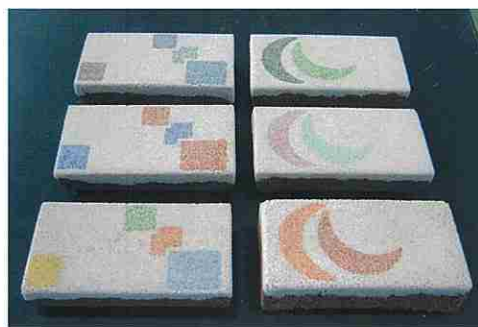
図 透水性舗装材料試作品(200*100*50mm)
