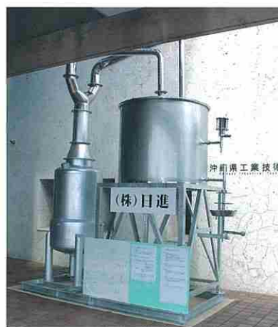
ものづくり研究会会員による泡盛蒸留機の試作機
