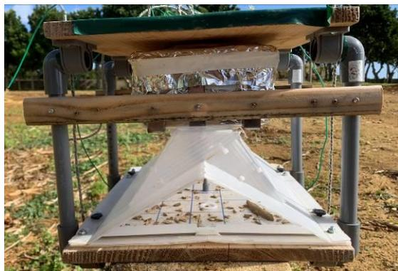
図3 野外に設置した自動撮影トラップ
