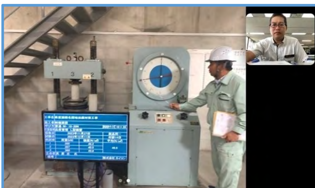
【圧縮強度試験 立会状況（工場側）】
