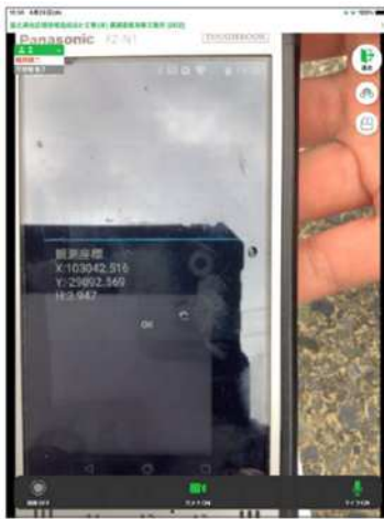
【GNSS精度確認】
