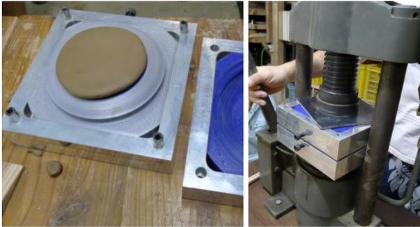
図8 PLA製プレス型(左)とプレス状況(右)
