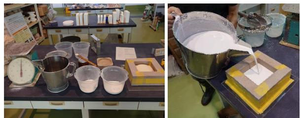
図6 使用した道具(左)と型への石膏注入(右)
