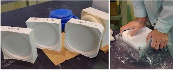
図7 製作した石膏型(左)とアルミ枠への嵌込(右)
