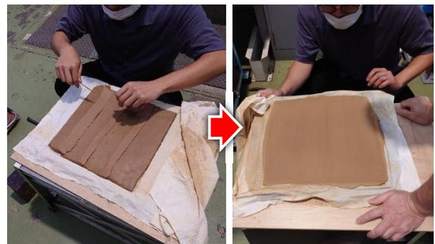
図13 短冊状に配置して枠内に充填させた
