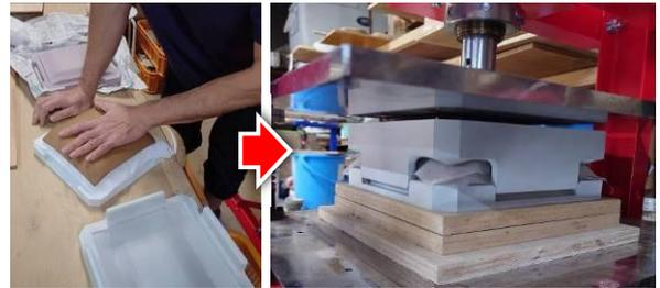
図 23 板状坯土の仕込みとプレス成形
