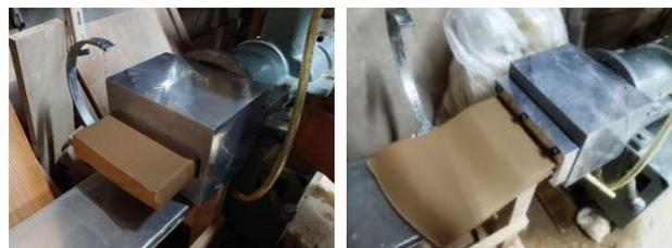
図 18 改良口金1枚出し(左)と2枚出し(右)
