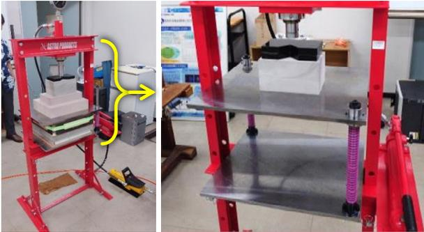
図 14 購入した簡易プレス機(右：後付け治具部)
