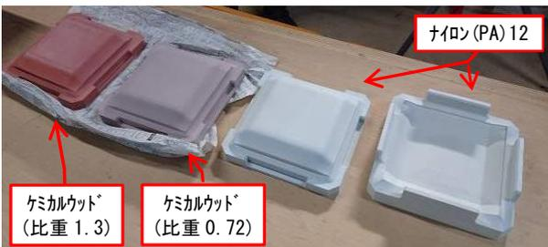
図 22 製作した 3 素材の雄型と雌型(右端)
