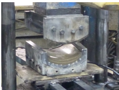
図1 試作瓦のプレス成形
