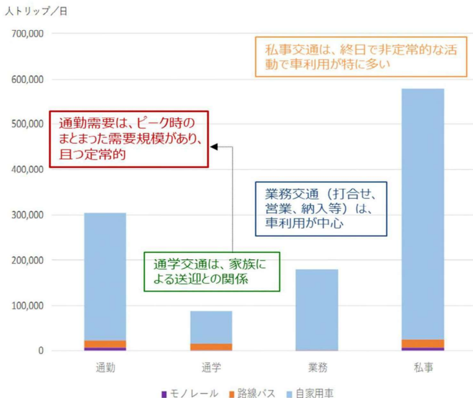
図 沖縄中南部都市圏（H18）の主な移動目的と手段別のトリップ数
