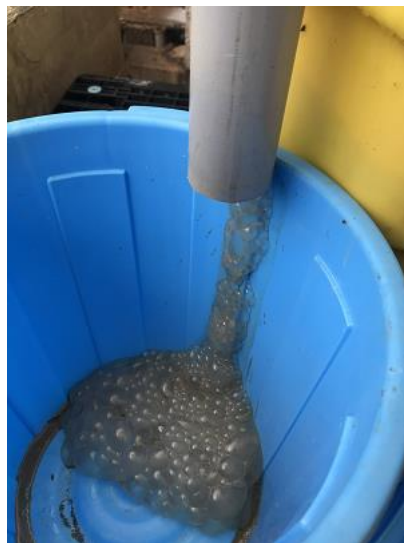
写真2 懸濁物排出状況(原汚水)
