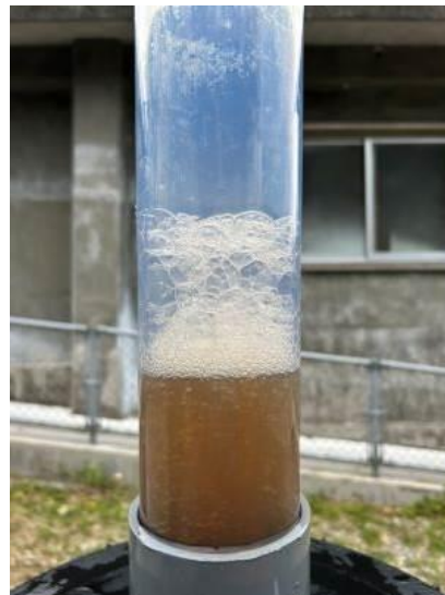
写真4 泡沫形成状況(浄化处理水)
