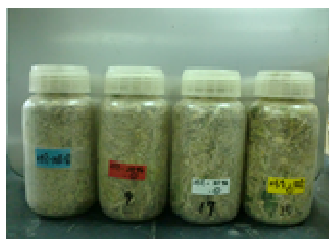
写真 4 ポリ容器詰め込み後の状態
