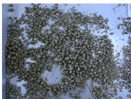
トランスバーラ粉末4：泡盛蒸留粕1 (ペレット化できず崩れた状態)
