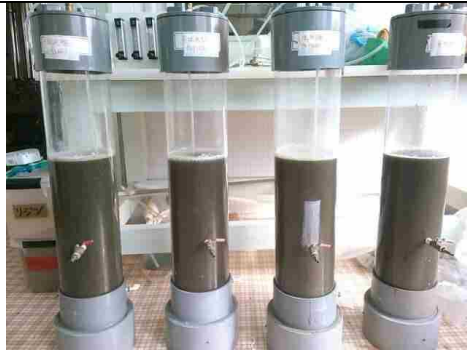
写真2 ばっ気試験用水槽
