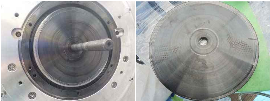
図 2-80 スラストカラー（ブレード側）左：DSS 前、右：DSS 後 擦痕の伸展なし
