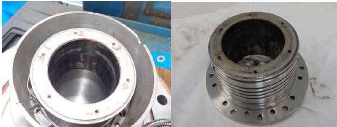
図 2-83 ラジアル軸受（後側）左：DSS 前、右：DSS 後 擦痕の程度はほぼ変わらない ラジアル軸受は、2016 年 3 月の点検後に新品に交換している
