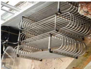
図1 投げ込み式楕円巻きチタン熱交換器
