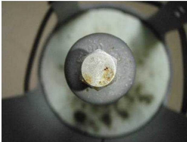
図-2 ボルトの頂端部
