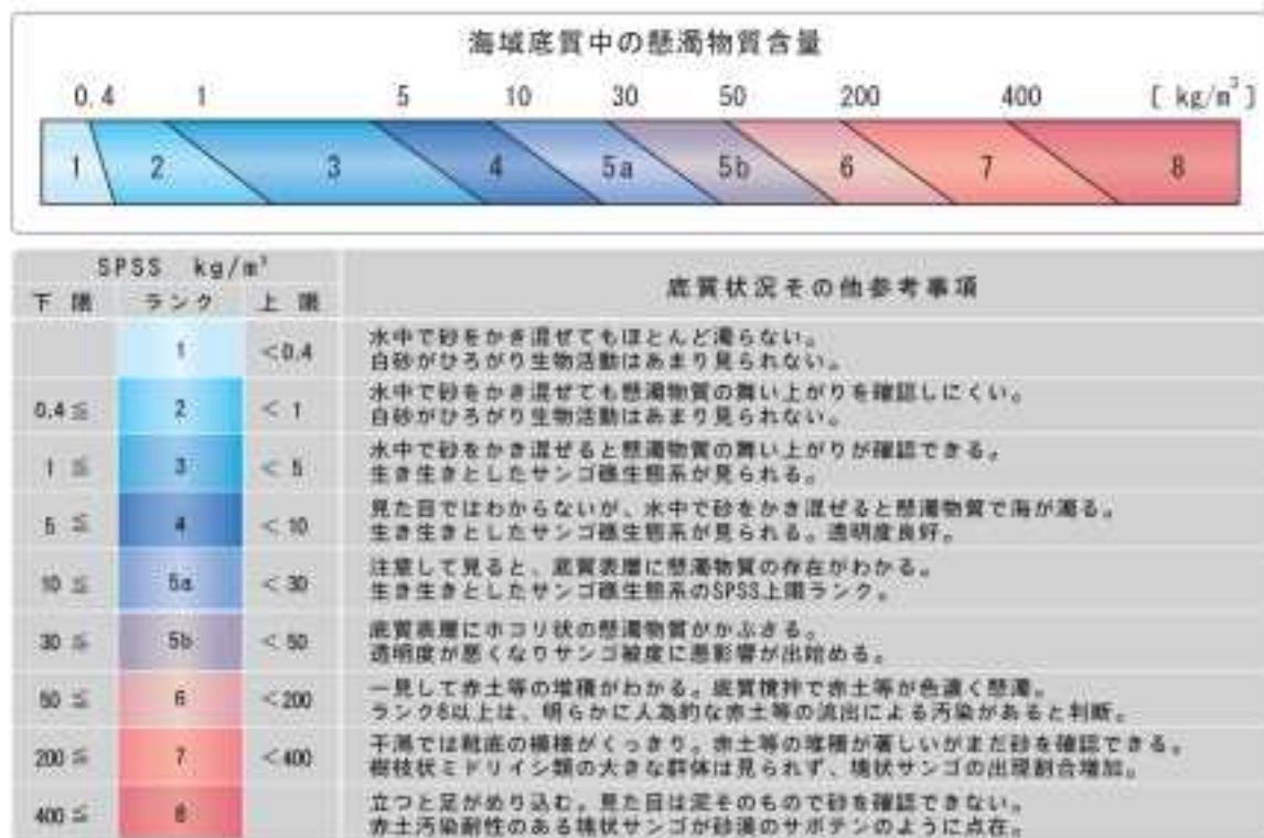
図 3.2-2 SPSS、SPSSランクと対応する底質状況その他参考事項 (「沖縄県の赤土流出について -赤土等ガイドブック-」より引用)
