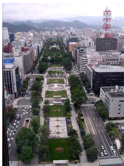
図 2.27 道路空間中央部分に公園を配置した札幌市大通公園の例
