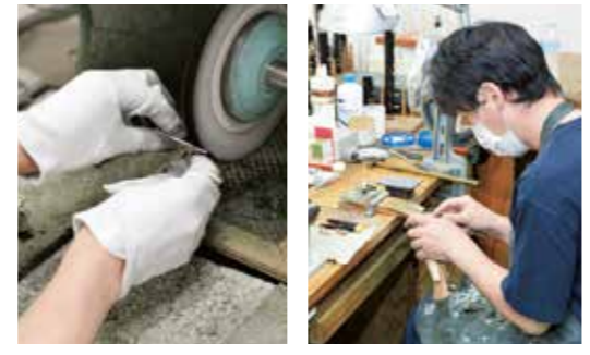
写真上:自動車製造などで使用する機械を楽器用に作ったという独自の旋盤機械。写真中:オーボエの場合、キーの磨きや取り付けなど50の工程があり、すべて分業制になっています。写真下:グラナディアやピンクアイボリーなどの原木を加工し、成形した楽器の一部。
