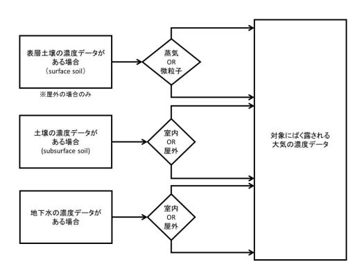
図 5-9 土壌・地下水データから大気の濃度を算定するプロセス
