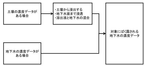
図 5-8 汚染物質の地下水の最高濃度の算定プロセス
