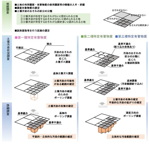
図 5-4 土壌汚染対策法に基づく調査の流れ
