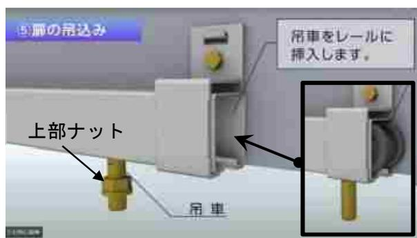
(c) ハンガーレールへの複車の設置と複車の上部ナットの取付け
