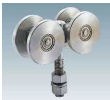
注1) 型番: #5S-4WH、材質: ステンレス SUS304、質量500kgfまで(2個吊り)、ボルト: M18
