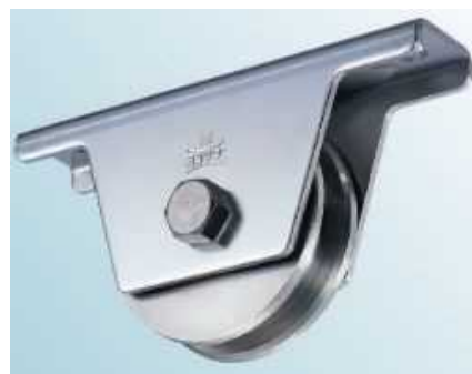
注2) 型番: JCS-1006、材質: ステンレス SUS304 (枠・ボルト)、SUS303 (車)、耐荷重1000kgfまで(2個あたり)
