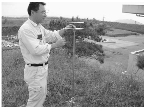
写真 - 1 多野岳山頂のダーラム型花粉捕集器
