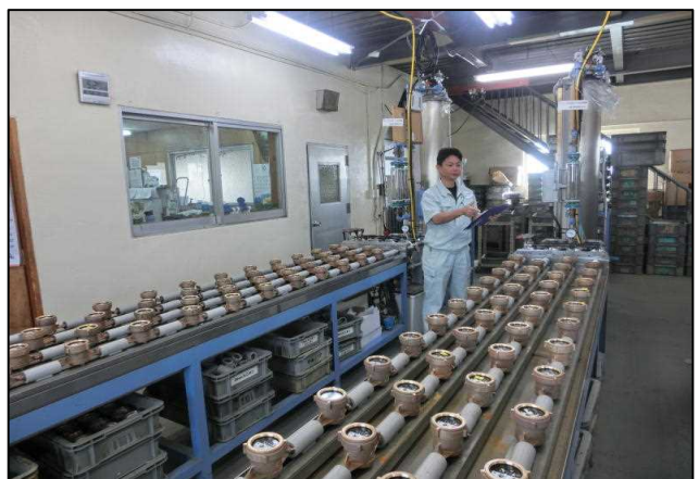
水道メーター検定の様子
