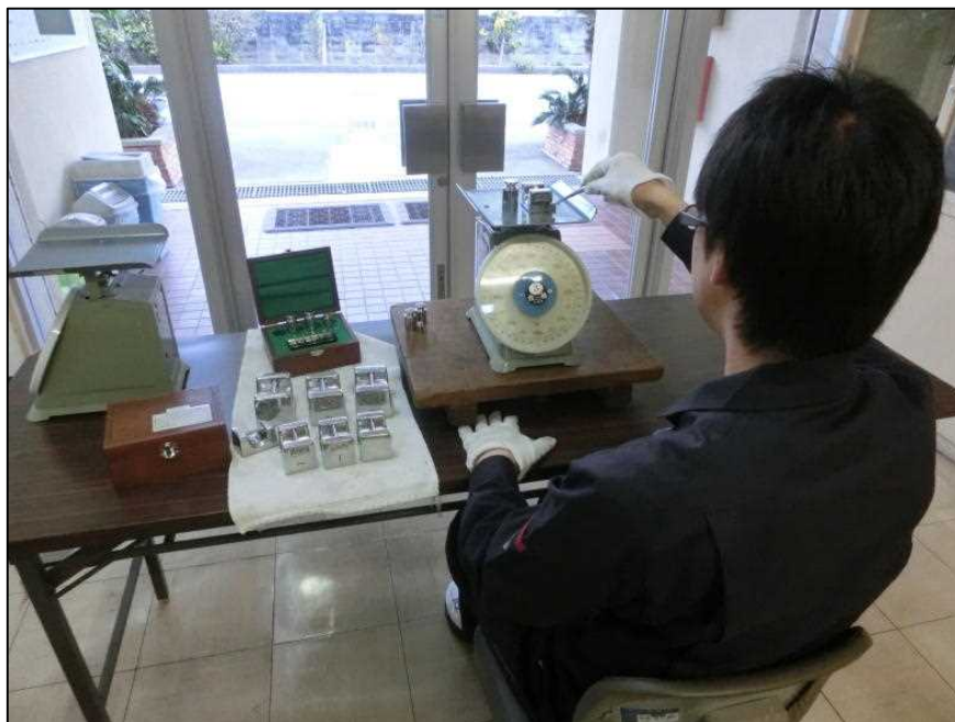
はかり定期検査の様子
