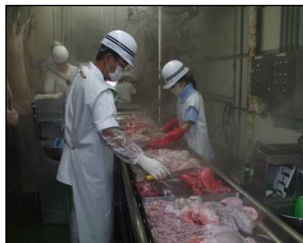
平成8年の腸管出血性大腸菌O-157の集団食中毒事件をきっかけに、平成14年までにと畜場の設備及び作業の見直しが進んだ。内臓は赤モツ・白モツに分別され、頭部はつり下げ方式、手指及び器具の一頭毎洗浄消毒の義務化により、各所に消毒用の設備が設置された。この時期と畜場の統廃合も相次いだ。
