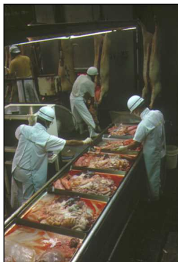
平成8年の腸管出血性大腸菌O-157の集団食中毒事件をきっかけに、平成14年までにと畜場の設備及び作業の見直しが進んだ。内臓は赤モツ・白モツに分別され、頭部はつり下げ方式、手指及び器具の一頭毎洗浄消毒の義務化により、各所に消毒用の設備が設置された。この時期と畜場の統廃合も相次いだ。
