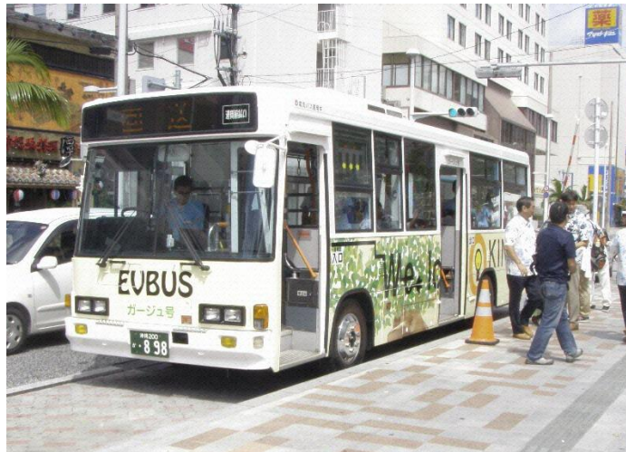
図 4-6 実証事業のため開発・導入した中型電気バス
