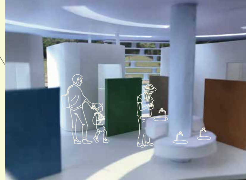
📷 4 【トイレ前手洗い】中央にある太い柱は、大きなガジュマルの幹のように屋根を支え、各トイレの間口がその幹に向かって配置されている。各トイレの上部は解放され、効率的な自然換気がなされる。
