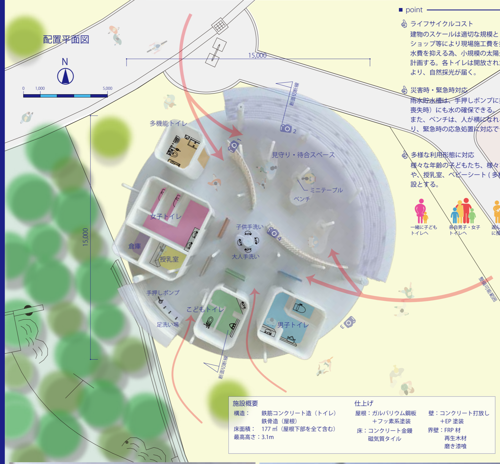
📷 4 【トイレ前手洗い】中央にある太い柱は、大きなガジュマルの幹のように屋根を支え、各トイレの間口がその幹に向かって配置されている。各トイレの上部は解放され、効率的な自然換気がなされる。
