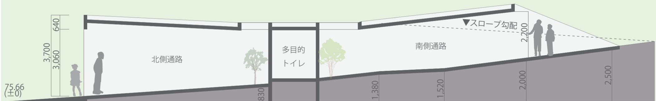
■基本的には傾斜に沿う形で断面計画し、全体的に高さをなるべく低く抑えてコストカットを狙う。北側の二つの出入口は低い位置から人が上ってくるような形になるので、先端の天井高を高くして引き込みやすい形状にする。南側の出入口は高い位置から入るので、天井高さを低く抑えて、さらにチューブを斜めにカットした形状とする事で圧迫感を無くし、入りやすい計画としている。
