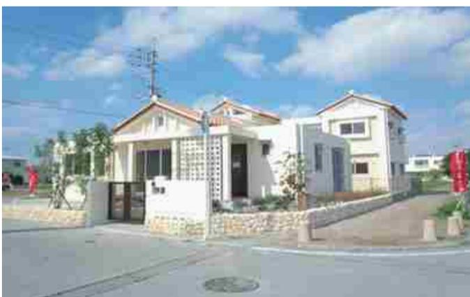
沖縄らしい住まいとして、夏を凌ぎ易くする為にコンクリートブロックと木造屋根赤瓦葺きの混構造をローコストで提供できるように工夫改善し、沖縄県の経営革新計画で承認を受けた住宅です。比較的ローコストのモデルハウスとして建築して販売しています。
