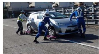
車両移動用ジャッキによる車両移動（NEXCO）
