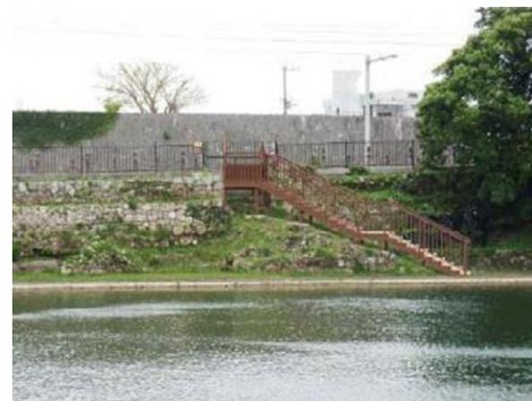
※主要部材：手摺り支柱(アルミ)、手摺り格子(アルミ)、手摺り笠木(合成木材)、床材(GRP材)
