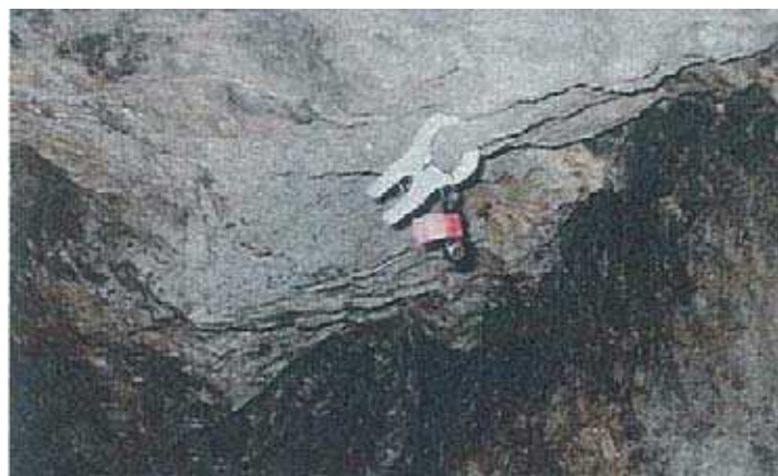
図 2.6.3 環境測定器設置状況
