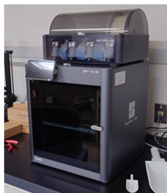
図6.3 材料押出法造形機
