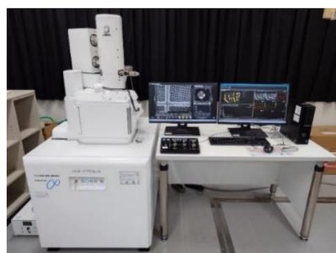
図6.1 電子顕微鏡
